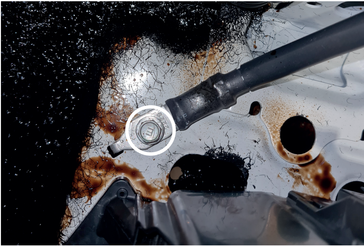
Original jordingskabel løsnes og flyttes til nytt punkt foran luftfilter boks som vist på 3. bildet.
